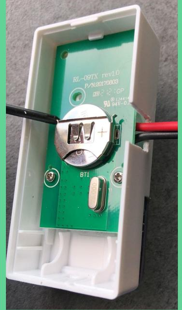
8º) Encajamos todos los elementos dentro de la carcasa y damos por finalizado el montaje.
